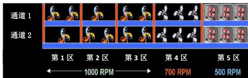
图 31. 后处理干燥机不同区域 (改造后)示意图 (CII, 2007)
